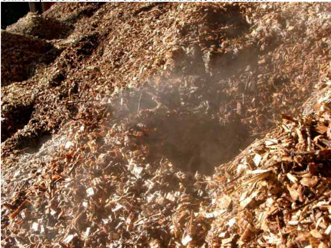
Plaquettes forestières en phase de séchage (60 et 70°) (photo – PNRM)
